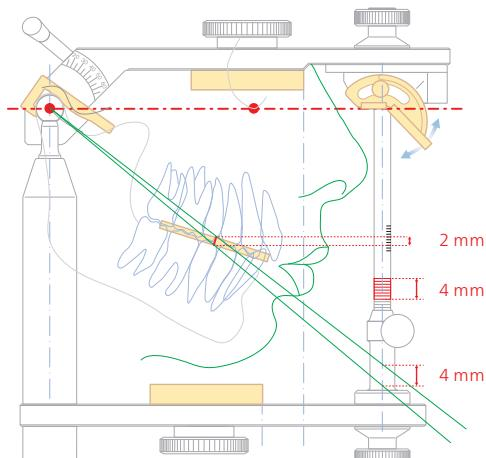
2.02 Высота резцового штифта устанавливается равной удвоенному значению измеренной толщины в области премоляра. Это скомпенсирует разницу по высоте после снятия регистратора.
