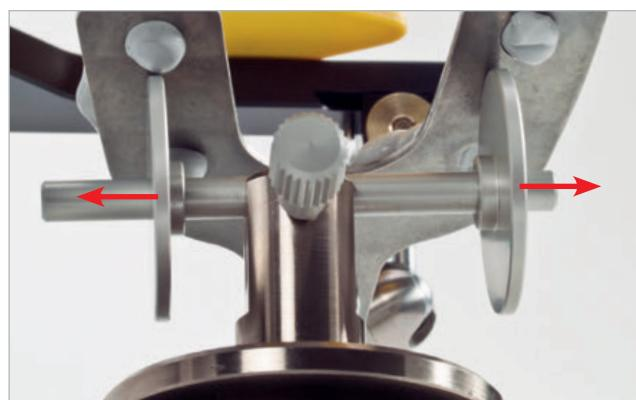
*kaldırılması gerekebilir. Bu diskler kolaylıkla tekrar ilerletilip ötelenebilir. Transfer çatalı olabildiğince merkezi olarak desteklenmelidir*
