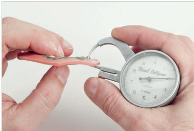
2.01 Измерить толщину по центру при помощи толщинометра. Самая толстая часть обычно располагается в области премоляра.
