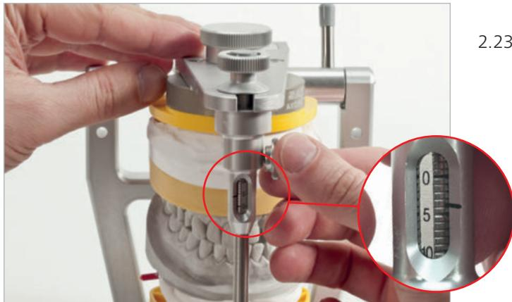
2.23 После снятия центрового регистратора резцовый штифт опускается (см. рисунок).
